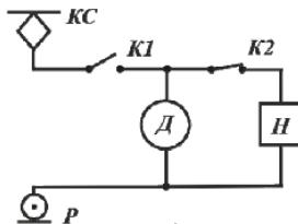
Рис. 1 – Структурная схема тягового привода с накопителем:  $KC$  – контактная сеть;  $P$  – рельс;  $K1, K2$  – ключи;  $D$  – тяговый двигатель;  $H$  – накопитель.
