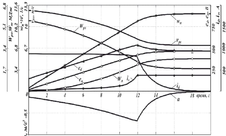
Рис. 3 – Процессы обмена энергией в системе «тяговый привод – накопитель» в режиме торможения электропоезда:
