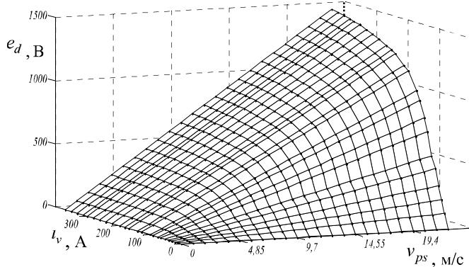
Рис. 2 – Зависимость ЭДС ТЭД  $e_d$  от скорости ЭПС  $v_{ps}$  и тока возбуждения  $i_v$ .
