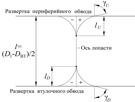
Рис. 1 – Схема сложного окружного навала лопастей РК.
