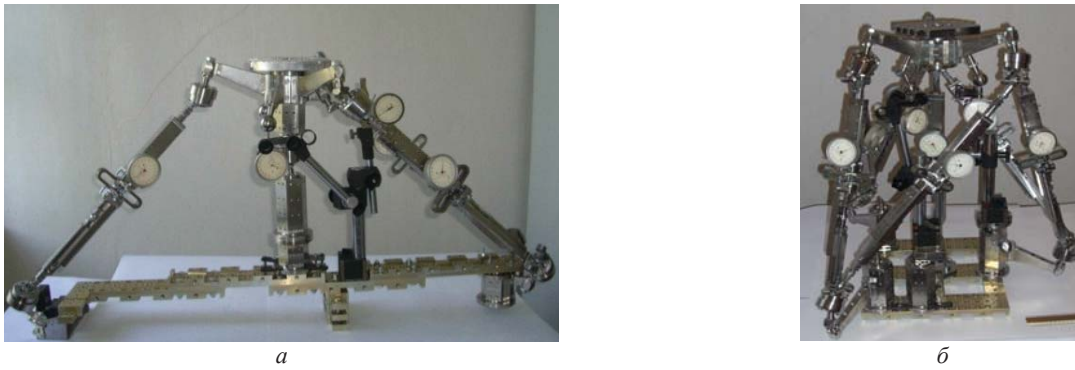
Рис. 6 – Макетні зразки просторових систем приводів, оснащені контрольно-вимірювальною апаратурою: a – механізм-трипод; б – механізм-гексапод.
