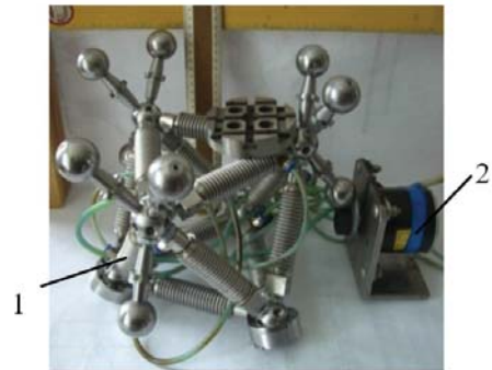
Рис. 12 – Установка 1 для визначення динамічних характеристик просторової системи приводів із пристроєм 2 для синусоїдального навантаження.
