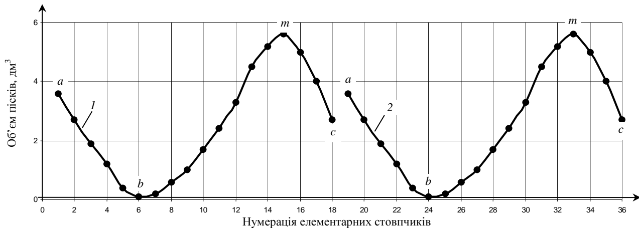
Рис. 1 – Розподіл об'єму твердого в елементарних стовпчиках довжиною \Delta l , розташованих вздовж піскових тіл: 1, 2 – відповідно перше і друге піскове тіло; a, b, m, c – характерні точки.
