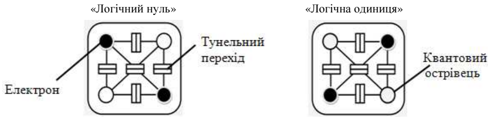
Рис. 5 – Базова комірка в двох можливих логічних станах.
