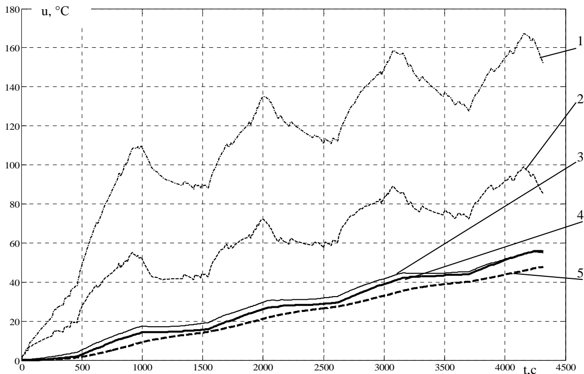
Рис. 4 – Результати моделювання теплового стану тягового двигуна АД917 вантажного електровозу на ділянках колії.
