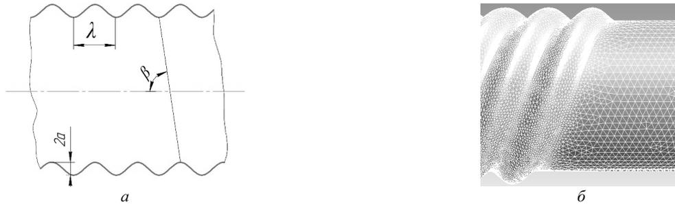
Рис. 1 – Геометрия трубы: а – геометрические параметры гофрирования; б – фрагмент расчетной сетки.
