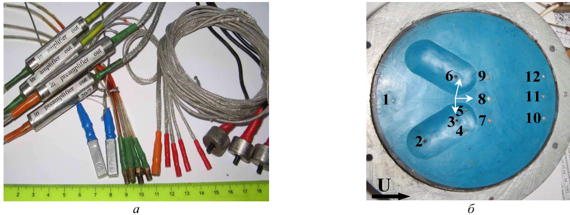
Рис. 2 – Пьезокерамические датчики пульсаций давления: а – датчики и усилители; б – расположение.
