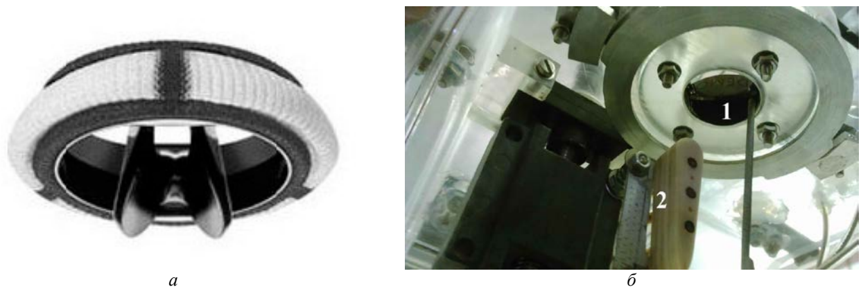
Рис. 1 – Двопелюстковий механічний клапан серця: а – відкритий; б – розташування над блоком датчиків.
