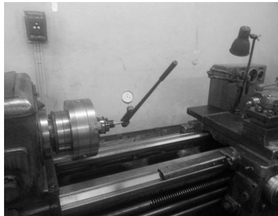
Рис. 3 – Измерение момента прокручивания M_{pr} оправки d=12 мм
