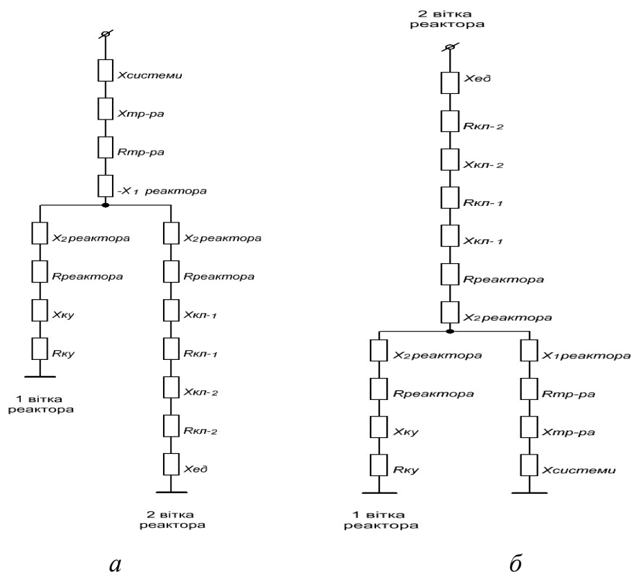
Рис. 3 – Схеми заміщення мережі для двох варіантів підключення ДВГ а – ДВГ знаходиться зовні віток реактору; б – ДВГ знаходиться у вітці з асинхронними електродвигунами
