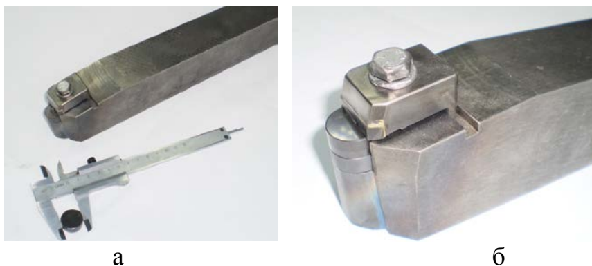
Рис. 2 – Внешний вид исследуемых инструментов: а – резец с механическим креплением сменных пластин; б – рабочая часть резца с установленной пластиной из гексанита
