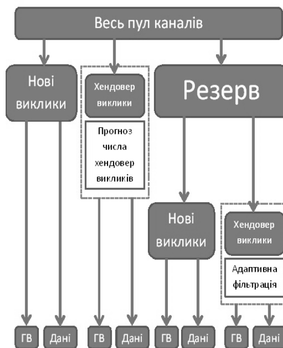
Рис. 5 – Спосіб балансування каналів, що відведення для хендовер викликів
