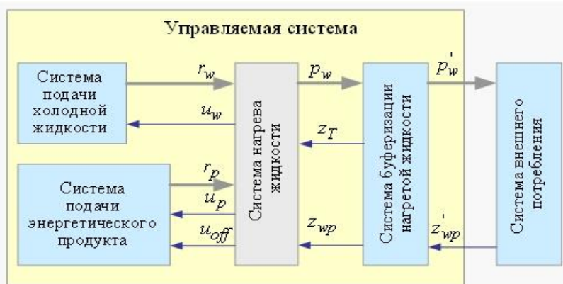
Рис. 1 – Управляемая система нагрева жидкости с возможностью оптимизации целевых операций
