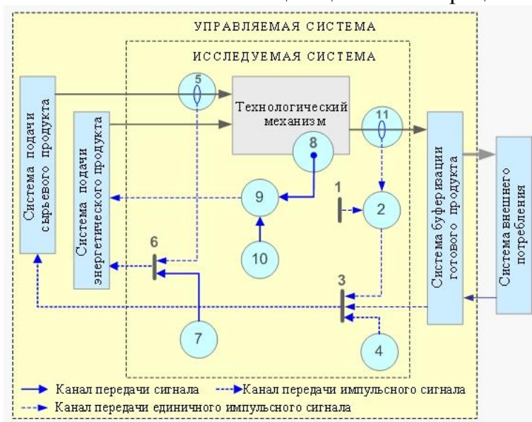
Рис. 2 – Управляемая система нагрева жидкости с детализацией синтезируемой системы нагрева: 1 - запуск системы; 2-мультиплексор; 3 - механизм синхронизации подачи данных; 4 - объект формирования-поддачи задающего сигнала относительно объема холодной жидкости; 5 - механизм регистрации момента завершения подачи холодной жидкости; 6 - механизм синхронизации подачи данных; 7 - объект формирования-поддачи задающего сигнала относительно интенсивности энергетического продукта; 8- механизм определения текущего значения температуры нагреваемой жидкости; 9 - компаратор; 10 - механизм подачи эталонного значения температуры нагрева; 11 - механизм регистрации момента завершения подачи нагретой жидкости
