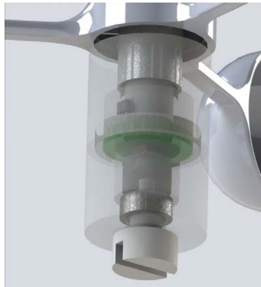
Рис. 5 – Спроектированная конструкция комбинированного датчика ветра
