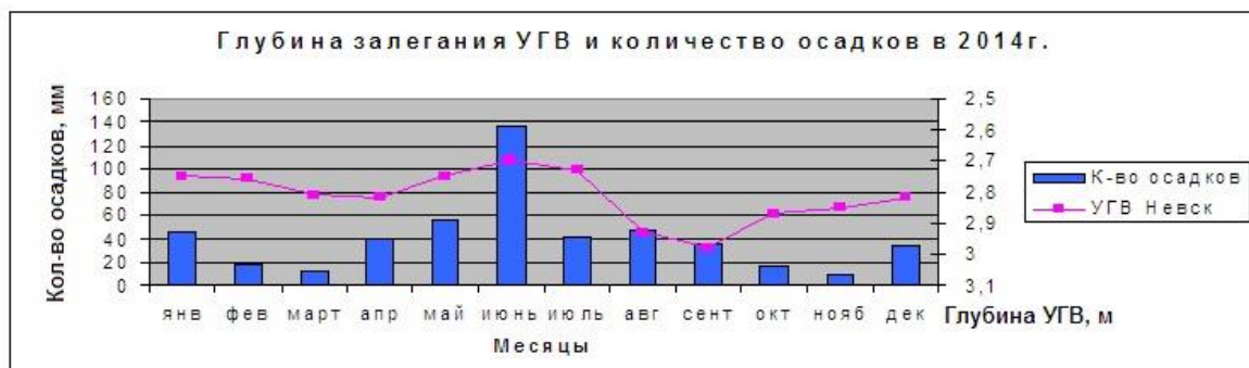
Рис. 7 – Результаты измерений глубины залегания УГВ в 2014г. в скважине по ул. Невского
