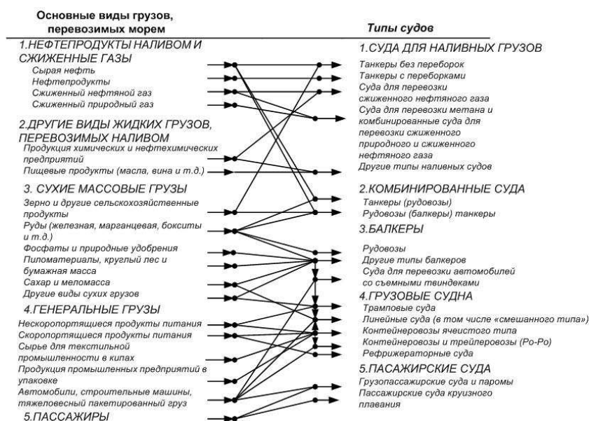
Рис. 1 - Схема тяготения основных видов перевозимых морем грузов к типам судов [2]
