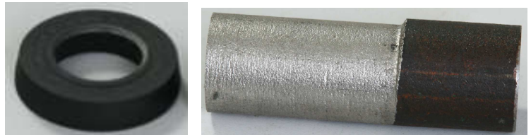
Рис. 3 - Электроды при обработке внешнего контура: а – инструмент; б – заготовка
