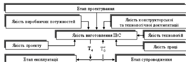
Рис. 3 - Структура показників якості етапу виробництва ІВС, де: T_4 – множина значень показників якості виготовлення (виробництва); T_0'' – зворотний зв'язок за показниками якості між етапами експлуатації (супроводу) та виробництва; T_3 – множина значень вихідних показників якості
