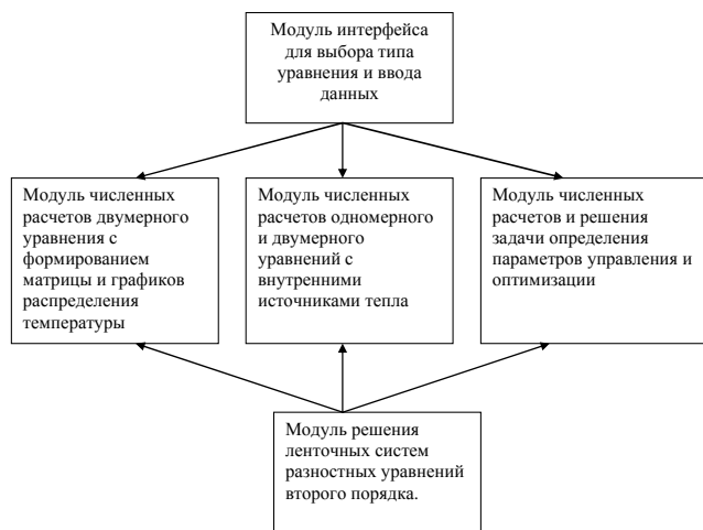
Рис. 3 - Структура алгоритма для определения параметров управления температурным полем
