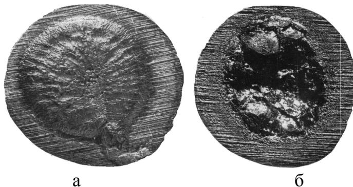
Рис. 3 - Вид излома биметаллического соединения Fe-Ti полученного рельефной контактной сваркой: а – при параметрах режима:  $Q = 11800 \text{ кА}^2$ ;  $T_k = 0,02 \text{ с}$ ;  $F_{сж} = 480 \text{ дан}$ ;  $F_{отр} = 200 \text{ дан}$ ; б – при оптимальных параметрах режима:  $Q = 9200 \text{ кА}^2$ ,  $T_k = 0,099 \text{ с}$ ;  $F_{сж} = 465 \text{ дан}$ ,  $F_{отр} = 445 \text{ дан}$ .
