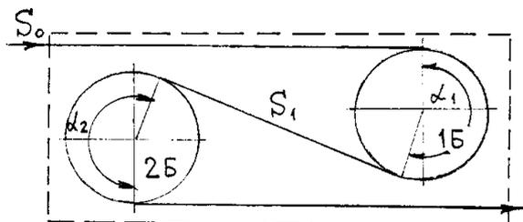
Рис. 1 - Расчетная схема двухбарабанного тянущего устройства конвейера
