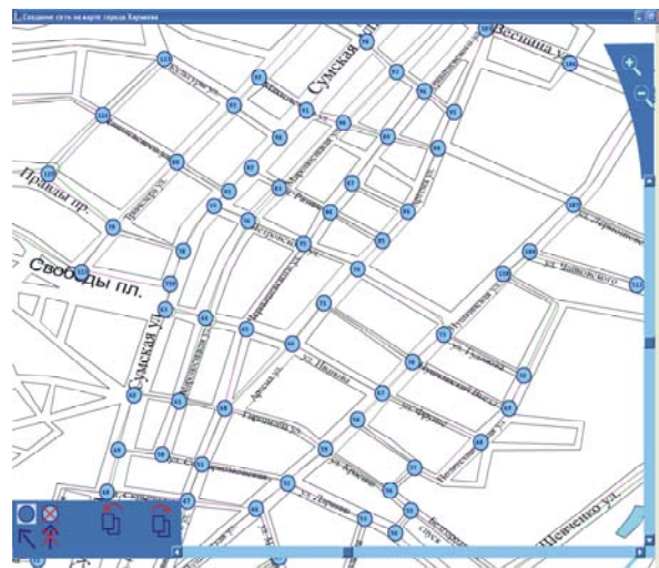
Рис. 1 – Фрагмент топологической схемы транспортной сети города
