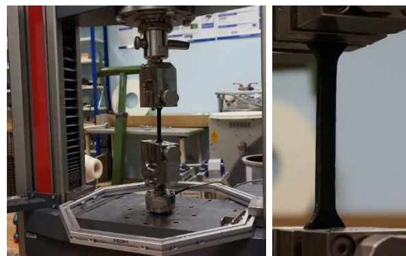
Рис. 2 – Фіксація зразків для випробувань в установці
