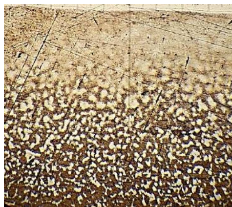
Рис. 8 – Структура упрочненной лазером зоны, \times 200 . Режим лазерной обработки: V_{об} = 0,3 м/мин; P = 500 Вт
