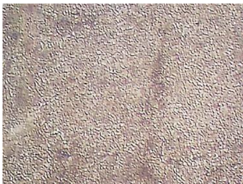
Рис. 5 – Структура стали 40 после улучшения, \times 200
