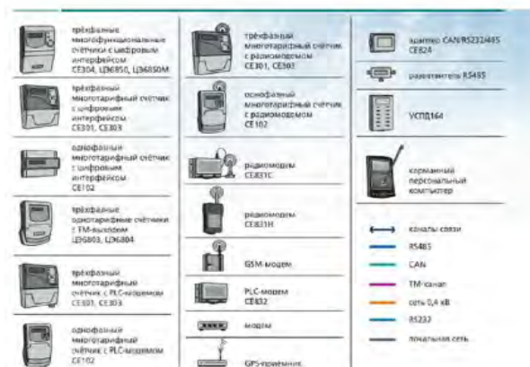
Рис.4 - Схема реалізації і технічні засоби оперативної системи
