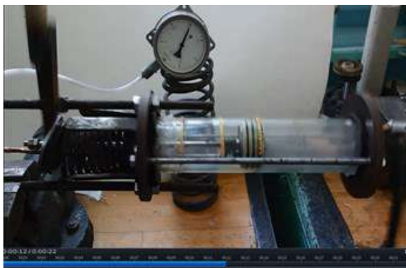
Фото 2. Положение поршня в момент высвобождения пружины. В области перед поршнем наблюдаются изменение цвета воздушной среды
