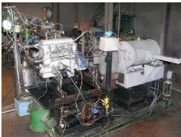
Рис. 5 – Стенд для дослідницьких та приймально-здавальних випробувань дизелів серії ДТНА
