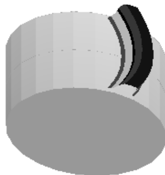
Рисунок 4 – Арочный зуб с циклоидальной формой
