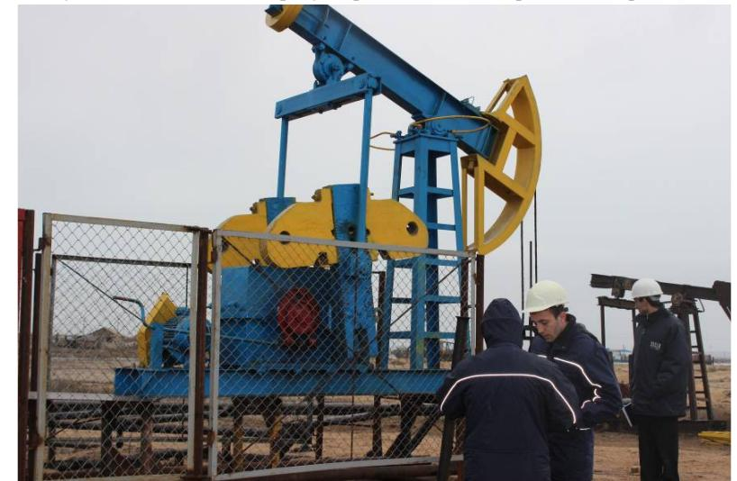
Рисунок 4 – Мониторинг работы станка-качалки СКД 3-1,5-710 с трехступенчатым двухпоточным пакетным редуктором с  $U_{\Sigma}=64$  на промысле Пираллахи
