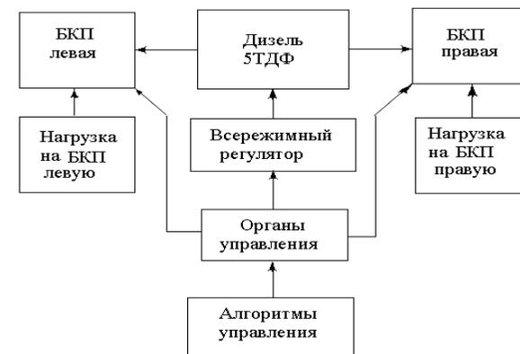
Рисунок 1 – Структурная схема силовой передачи танка Т-64А
