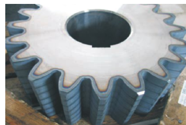
Рисунок 2 – Шестерня с диаметром d=50\text{мм} с поверхностной заковкой посредством лазерного луча [5]
