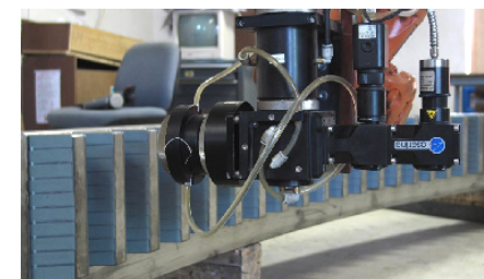
Рисунок 3 – Шестерня с диаметром d=2500\text{мм} с поверхностной заковкой посредством лазерного луча [5]
