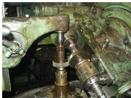
Рисунок 3 – Изготовление квазиглобoidного колеса
