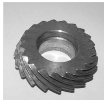
Рисунок 4 – Квазиглобoidное колесо с z_1=20 ; m=1,5 ; \beta=60^\circ
