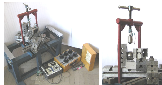
Рисунок 3 – Общий вид экспериментальной установки для исследования контактного взаимодействия
