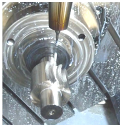
Рисунок 7 – Черновое фрезерование арочных зубьев
