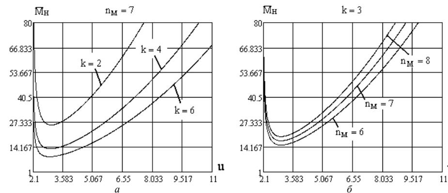
Рисунок 2 – График зависимости функции аналога массы  $\overline{M}_H = \overline{M}_H(u)$  при различных значениях:  $a$  – параметра  $k$ ;  $b$  – параметра  $n_M$
