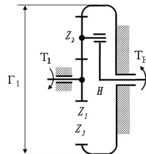
Рисунок 1 – Схема простого планетарного механизма типа АІ
