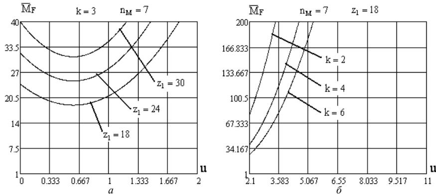
Рисунок 4 – График зависимости функции аналога массы  $\overline{M}_F = \overline{M}_F(u)$  при различных значениях:  $a$  – параметра  $k$ ;  $b$  – параметра  $z_1$
