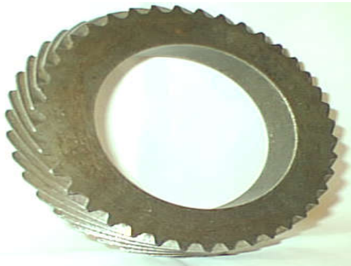
Рис. 3 – Квазигіперболоїдне колесо с z_2 = 40 ; m = 1,5 мм; \beta = 60^\circ
