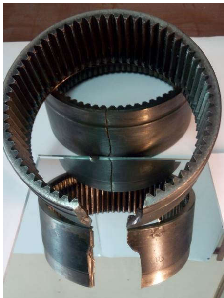
Рис. 1 – Фото утомних руйнувань епіциклів ПКР типу Raba 118.77
