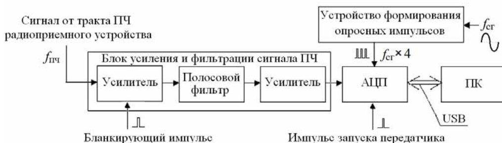
Рис. 2. Структурная схема подсистемы приема и обработки сигнала на промежуточной частоте
