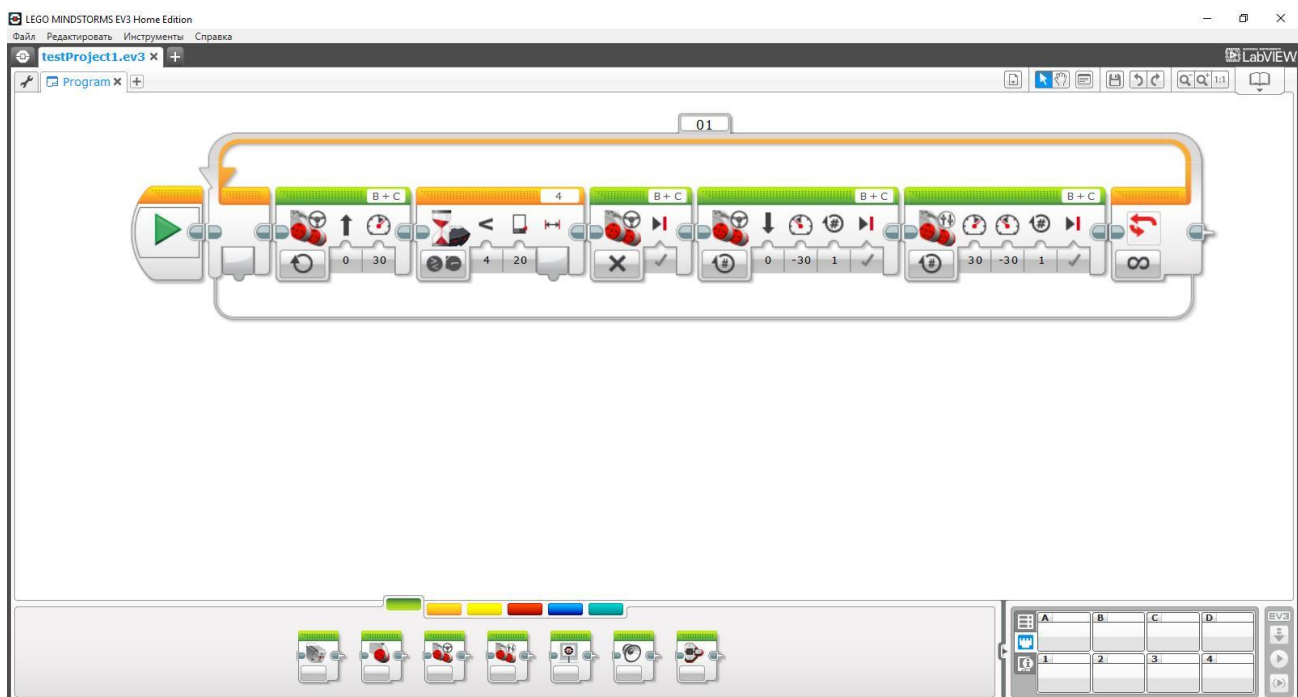
Рис. 1. Приклад програмування робота-«інтроверта» засобами середовища LEGO MINDSTORMS EV3 Home Edition
