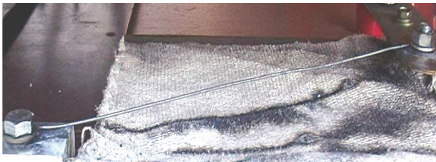
Рисунок 2 – Внешний вид исходного круглого оцинкованного стального провода ( r_0 = 0,8 мм; l_0 = 320 мм; \Delta_0 = 5 мкм; S_0 = 2,01 мм 2 ), размещенного в воздухе над теплозащитным асбестовым полотном, до протекания по нему в разрядной цепи высоковольтного генератора ГИТ-5С аперiodического импульса тока большой плотности [11]
