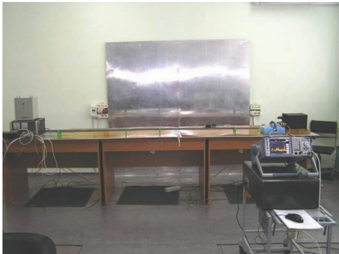
Рисунок 13 – Рабочее место при измерении эмиссии тока радиопомех
