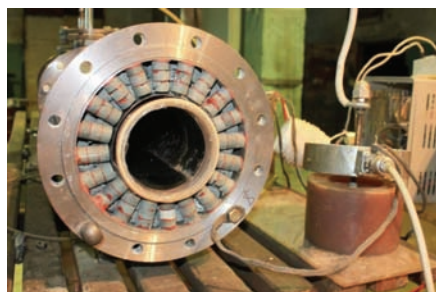
Рисунок 8 – Фотография реактора для получения импульсного барьерного разряда с катализатором
