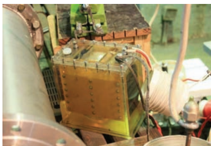
Рисунок 6 – Фотография импульсного трансформатора ИТ 2
