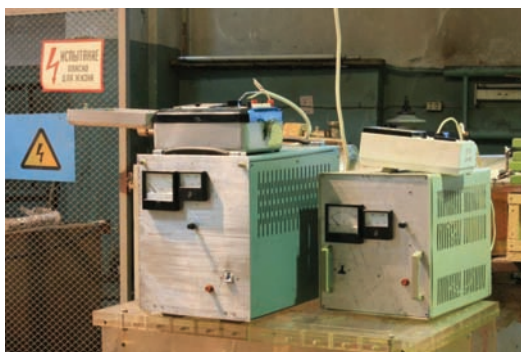
Рисунок 4 – Фотография низковольтный генераторов импульсов созданной электрофизической установки
