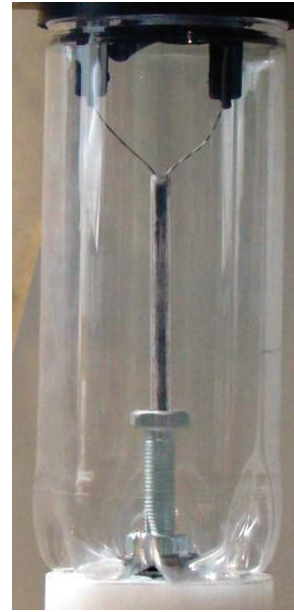
Рисунок 3 – Технологический узел лабораторной установки разрядноимпульсной инициации СВС
