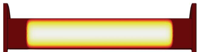
Рисунок 13 – Распределение температурного поля шунта
