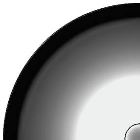
Рисунок 16 – Распределение температурного поля дискового шунта на резистивной пластине
