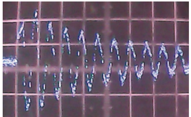
Рисунок 12 – Поле в дальней зоне, физическое моделирование (V – антенна, длина плеч 60 см, угол раскрытия 60°, 10 нс /дел., осциллограф С7-7)
