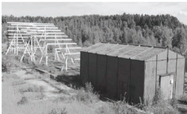
Рисунок 1 – Стационарный имитатор ЭМИ ЯВ «Аллюр» ФГУП ВЭИ (г. Истра, Московской обл.). Габариты имитатора: 100 x 35 x 13,5 м; рабочий объем: 10×10×10 м; форма импульса: 2,5/25 нс; максимальная напряженность импульса электрического поля: 70 кВ/м
