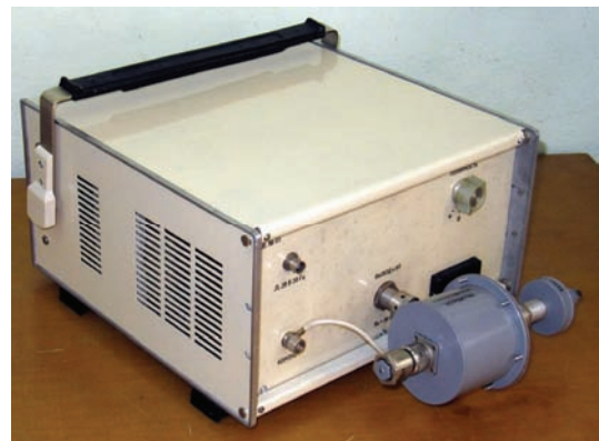
Рисунок 6 – Общий вид испытательной установки TI-CS115(NCS08) в режиме калибровки
