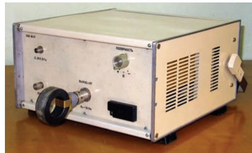
Рисунок 12 – Общий вид испытательной установки TI-CS115(NCS08) в режиме испытаний
