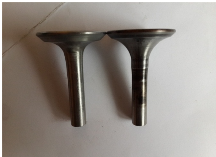
Рис. 3 – Дослідні зразки випускних клапанів
