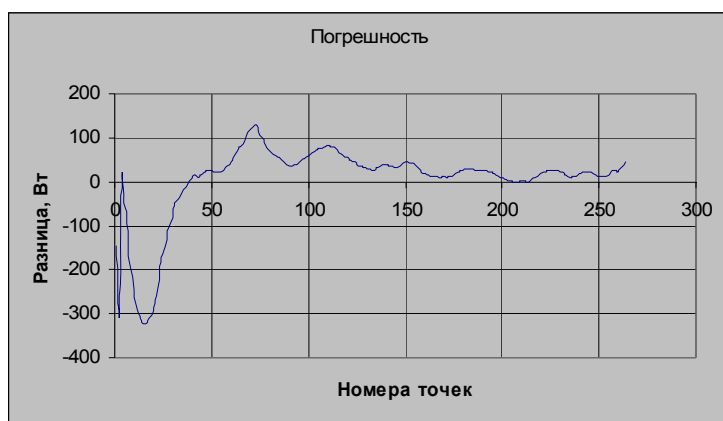
Рис. 3 – Разность между вычисленными и экспериментальными значениями мощности
