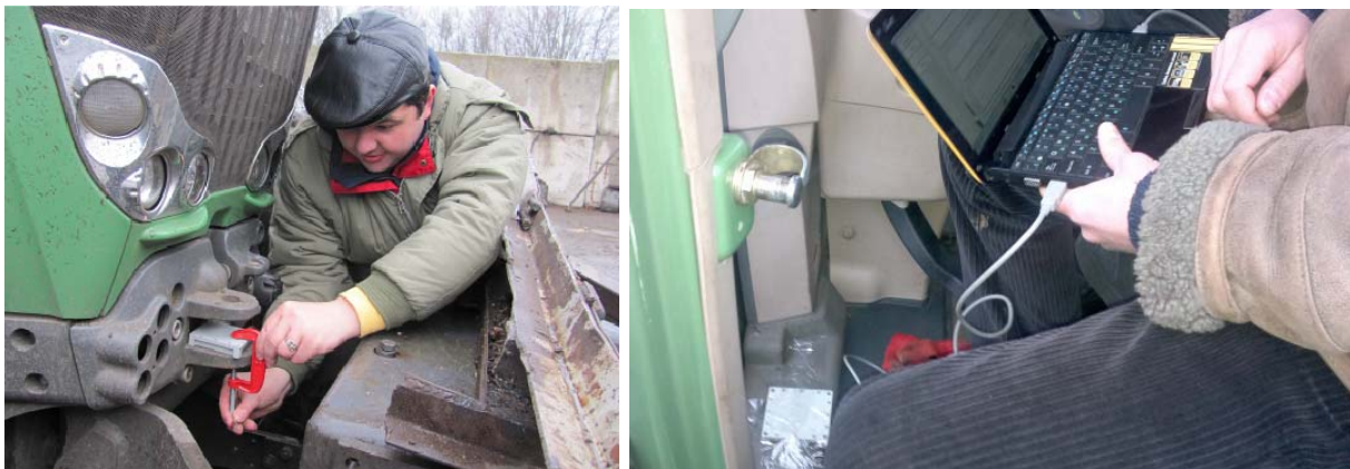
Рис. 4 – Встановлення і налаштування мобільного вимірювального комплексу на тракторі Fendt 936 Varіo
